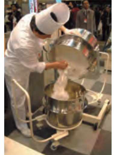
ショートタイプ (SBS1-60ST) はボール転倒装置として非常に便利です。
